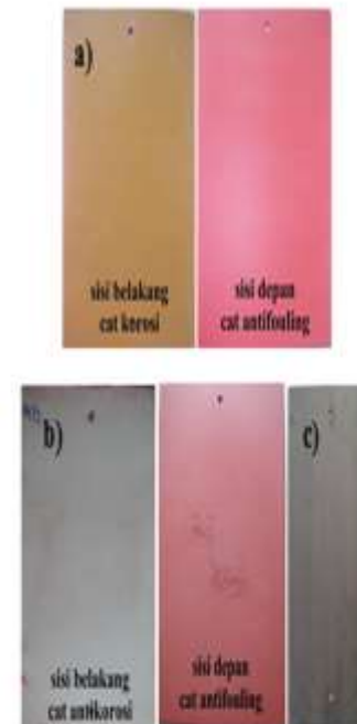
Gambar 1. Sampel uji sebelum ekpos, lapis lindung cat A (a), lapis lindung cat B (b), tanpa lapis lindung (c)
