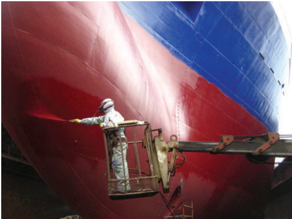
Gambar 4.1. Perlindungan Terhadap Biota Penempel Menggunakan Cat Antifouling
