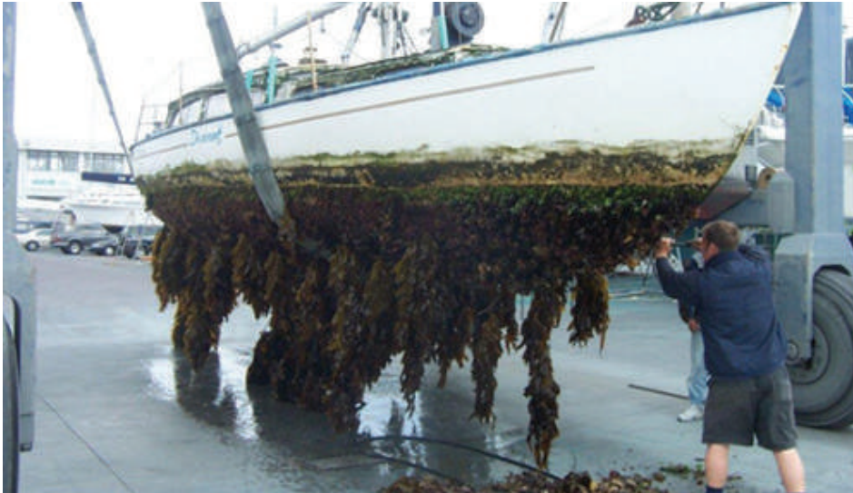
Gambar 4.2. Pengelupasan Biota Penempel Secara Mekanis ( Scrapping )
