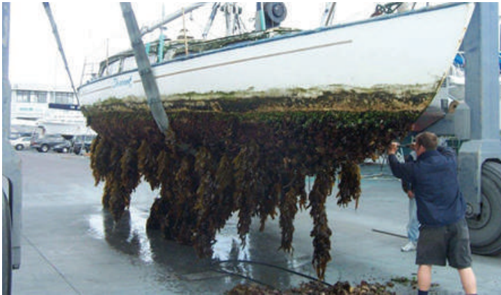
Gambar 3.4. Penempelan Biota pada Kapal Laut
