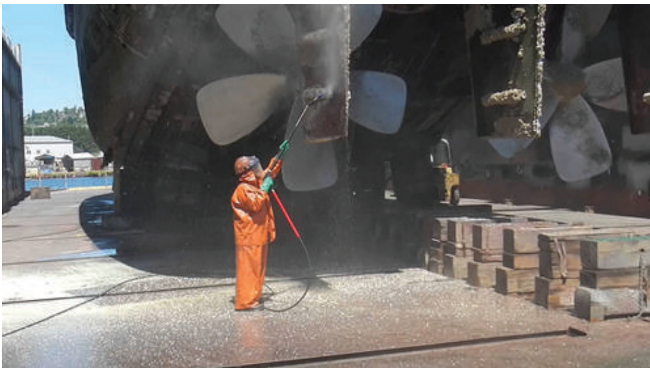
Gambar 4.3. Pengelupasan Biota Penempel Secara Mekanis ( High Pressure Water Jetting )
